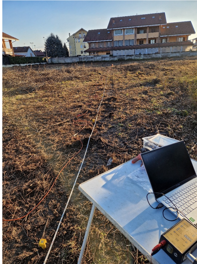
Foto n.1 – Stendimento rilievo sismico MASW
